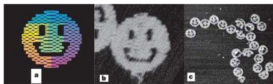
Fig. 10. (a) 构造一个“DNA笑脸”的折叠路径。偶数个双螺旋结构被填充在这个形状里。(b), (c) 一个长的单链DNA片段自我组装,形成想要得到的形状(原子力显微镜图片)。(取自Rothemund, P., Nature, 440, 297, 2006.)
